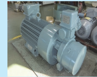
整備完成品 (高圧モータ)
